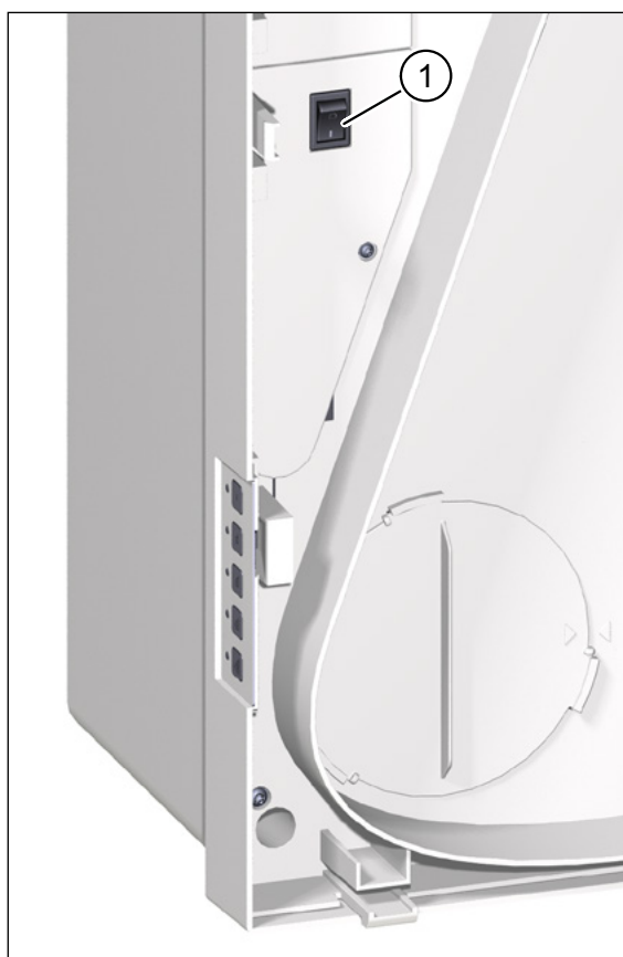
Obr. 12: Síťový spínač, viditelný po sejmutí víka přístroje
