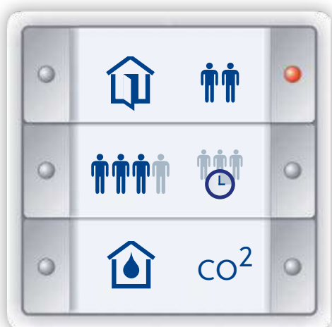
Dotykový senzor InControl s indikací LED
