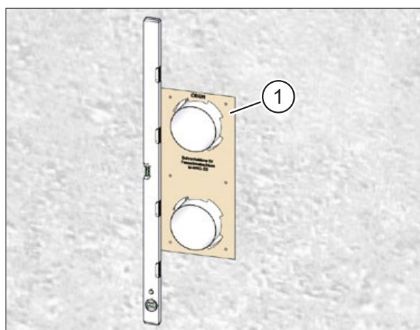
Obr. 15: potrubí větrání na vnější stěně
